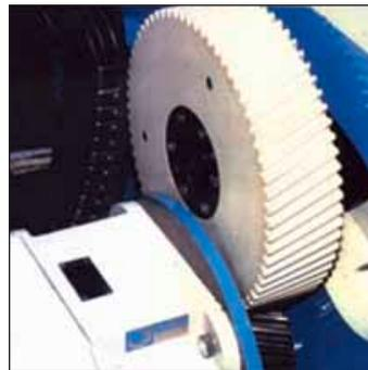
Mit einem Modul  $m=5$  mm überträgt ZX-100K 38 kW im Trockenlauf und sorgt dabei für einen geräuscharmen Antrieb.
