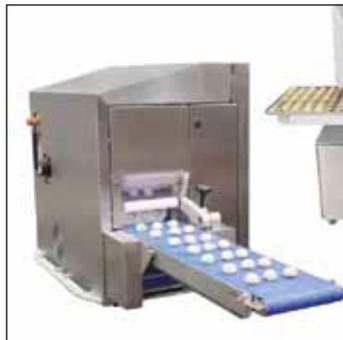
In Industriebäckereien werden Bauteile aus ZX-100K vor allem aufgrund der guten antiadhäsiven Eigenschaft erfolgreich eingesetzt. Der Werkstoff ist für den direkten Kontakt mit Lebensmitteln zugelassen und entspricht der Kunststoffverordnung EU 10/2011.
