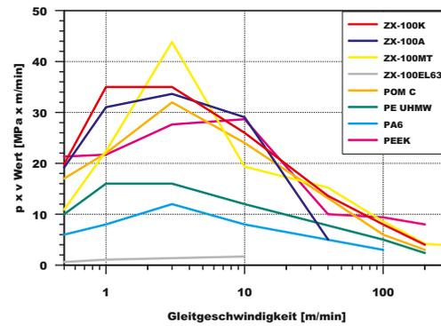
ZX-100K weist bis 10m/min Gleitgeschwindigkeit einen höheren pv-Wert als PEEK auf. PE UHMW, PA6 sind für Gleitbeanspruchung weniger geeignet.
