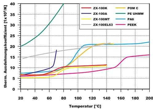
Der thermische Ausdehnungskoeffizient von ZX-100K ist kleiner als der von POM, PE UHMW und PA6. Präzisere Anwendungen werden möglich.
