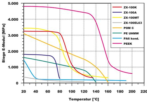
ZX-100K verliert bis 90°C nur wenig an Steifigkeit. Der Steifigkeitsverlust bei erhöhten Temperaturen muss bei allen Kunststoffen beachtet werden.
