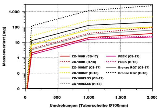
ZX-100K ist bei stark abrasiven Verschleiß (H-18) gegenüber Bronze 30 mal besser und bei geringerer abrasiver Wirkung (CS-17) annähernd so gut wie PEEK.
