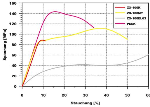
Aufgrund der Mineralverstärkung konnte bei ZX-100MT sowohl die Steifigkeit (annähernd wie PEEK), als auch die Druckfestigkeit gegenüber dem Grundtyp ZX-100K erhöht werden.
