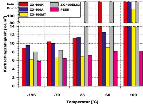
Elastomer modifiziertes ZX-100EL63 weist die höchste Kerbschlagzähigkeit auf. ZX-100K und ZX-100MT liegen auf den Niveau von PEEK.
