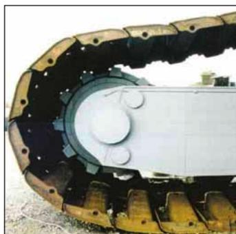
ZX-100K wird in rauer und schmutziger Umgebung als Gleitlager in Fahrwerken von LKW, Baggern und Bergbaumaschinen eingesetzt.
