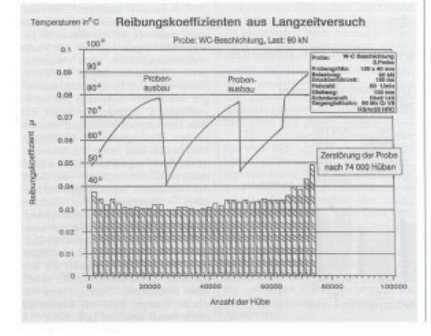
dieser Effekt in höheren Belastungsbereichen (Last: über 90 kN) um, so daß sich belastungsabhängige Reibwert-Minima bilden. Für den Kunststoff-Gleitbelag ZX 100 zeigt dieses Verhalten beispielhaft Bild 8.
