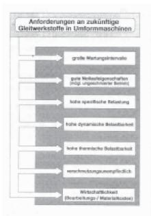
Bild 3. Zielsetzungen für Gleitwerkstoffe in Umformmaschinen
