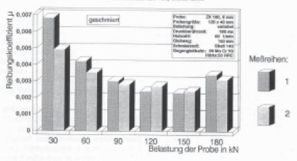
Prüfwerkstoff: ZX 100, Dicke: 8mm
