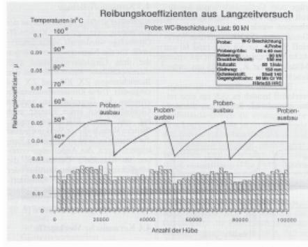
Bild 9. Reibbeiwerte und Temperaturen aus dem Langzeitversuch der Wolframkarbid-Gleitprobe 4
