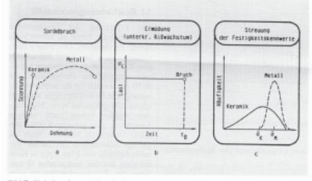
Bild 7. Verhalten keramischer Werkstoffe unter mechanischer Belastung [11]
